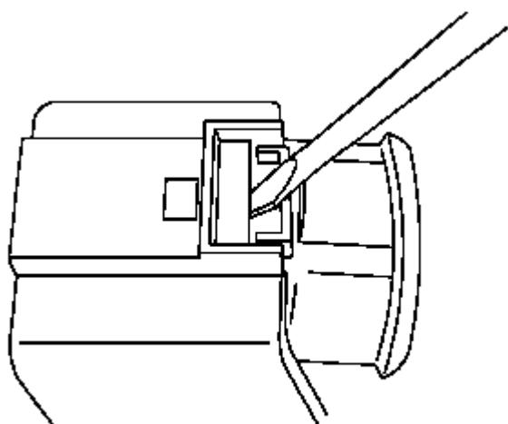
2.向下锁舌以松开连接器。可能需要向下按压小号平刃工具，并略微向后倾斜，以便按下锁舌。当松开锁舌断开连接器时，拉动连接器壳体。
